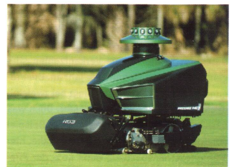
Der Greensmäher PG 3 empfängt sein Signal per Ultraschall bei Reichweiten von 40 m.
