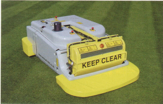
Der MAS 01 von McMurtry ortet sich über ein Lasersignal. | Fotos: F. Hemmerich.
