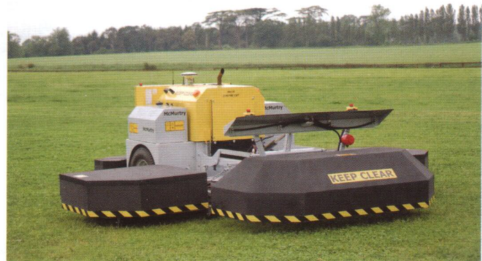
Der MAS 05 von McMurtry erhält seine Steuersignale über GPS.
